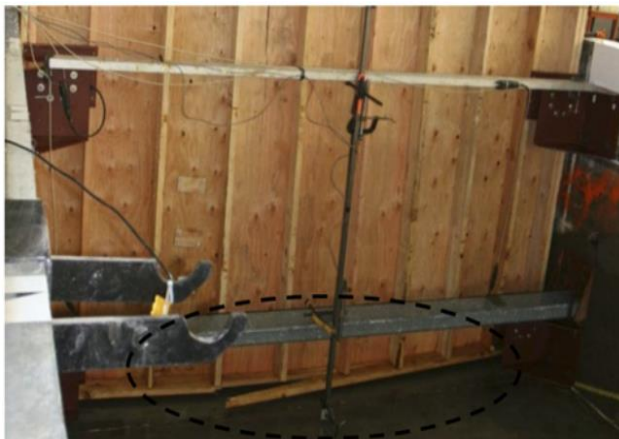
(a) Prototipe dinding kayu dan pola keruntuhannya
