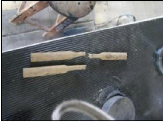
**Gambar 3.3** Benda Uji Tarik Bambu setelah Putus
