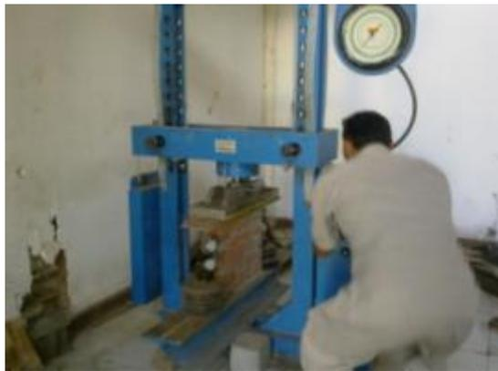
**Gambar 3.1** Pengujian Pasangan Batu Bata, Spesi 1pc : 4ps
