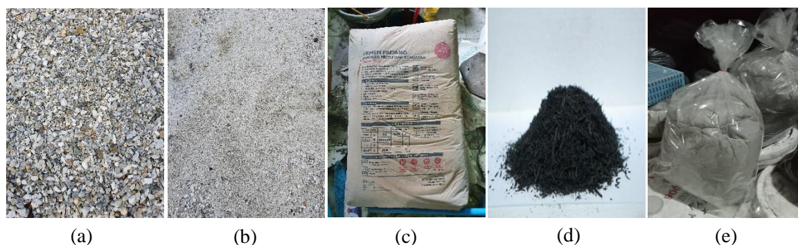
Gambar 1. Bahan penyusun benda uji (a) agregat kasar (b) agregat halus (c) semen PCC (d) remah karet (e) FABA
