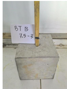
Gambar 8 Hasil pengujian lekatan BT B 7.5-3
