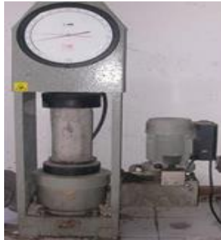
Gambar 3 Pengujian kuat tekan beton
