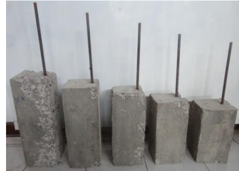
Gambar 9. Benda uji sengkang d 4,7 mm
