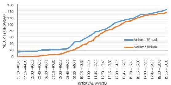
Gambar 6 Grafik kumulatif volume on street parking untuk kendaraan ringan di Jalan Diponegoro
