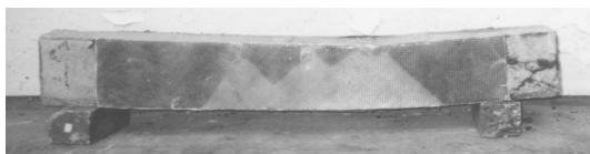
Gambar 11. Foto keruntuhan balok lapis GFRP dgn arah serat \pm 45^\circ
