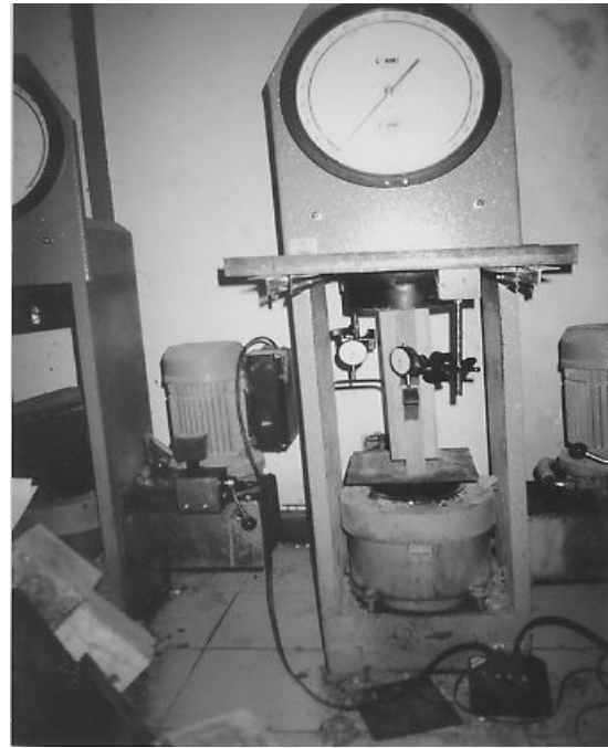
Gambar 2. Pengujian kekuatan sambungan perkat
