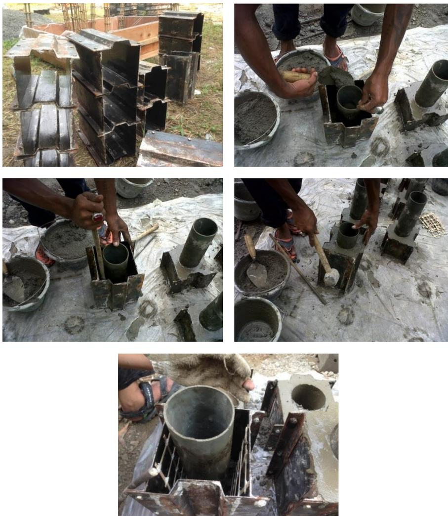
Gambar 2. Proses pembuatan bata berongga
