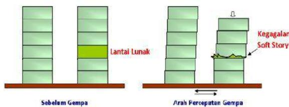
Gambar 5. Ilustrasi *Soft Storey*
