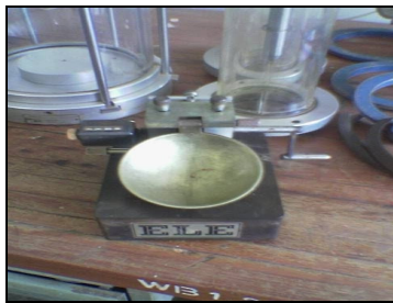
Gambar 2 Alat Casagrande (Ir.G. Djatmoko Soedarmo dan Ir.S.J. Edy Purnomo, 1993)
