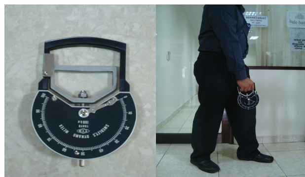
Gambar 1. Dinamometer dan cara mengukur kekuatan genggaman tangan
