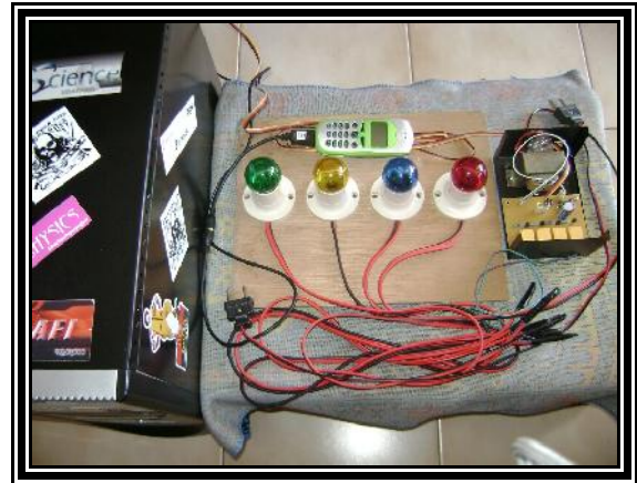
Gambar 2. Sistem Kontrol Lampu Dengan SMS Berbasis Komputer.
