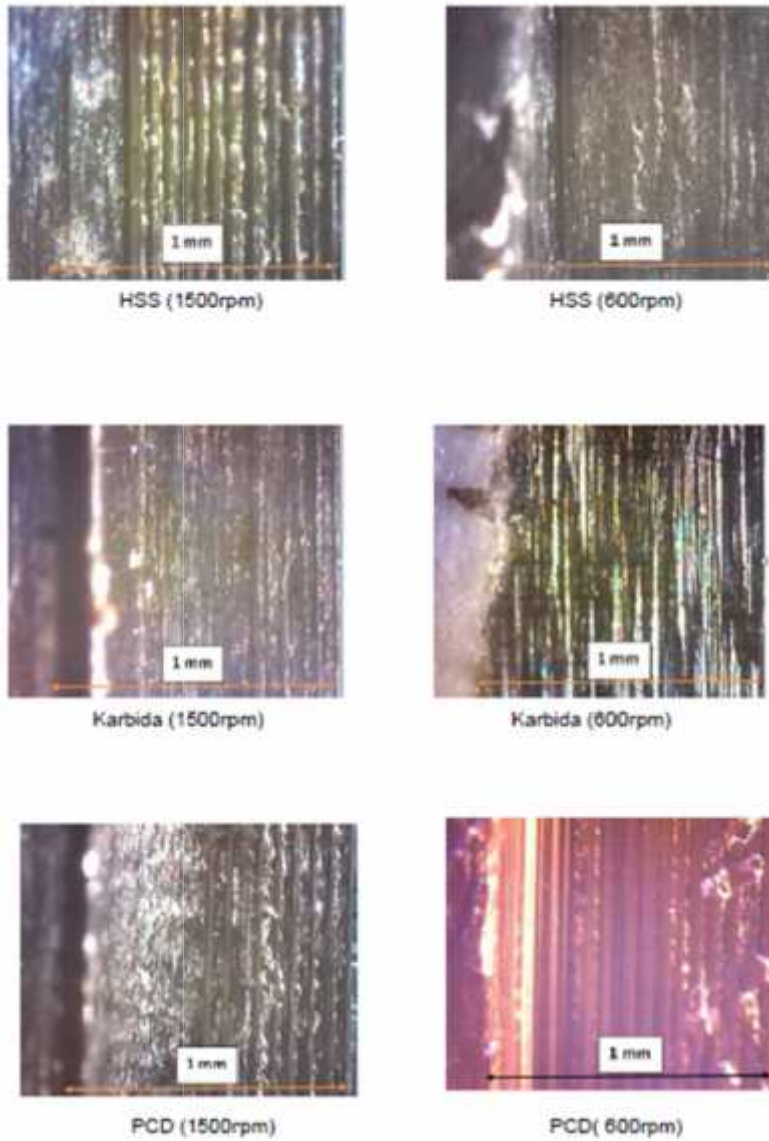
Gambar.5. Foto makro 30x permukaan stainless steel dibubut dengan pahat yang berbeda-beda
