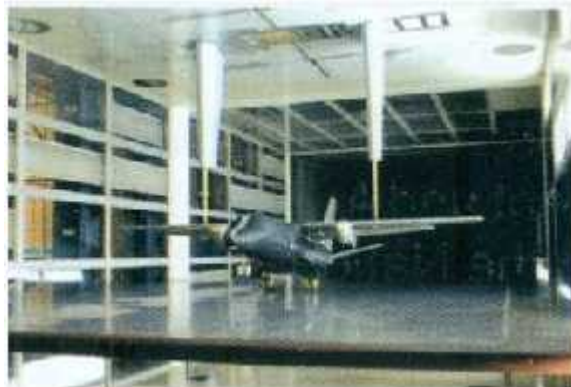
Gambar 4. Pengujian aerodinamika pesawat dengan metoda pengukuran gaya
