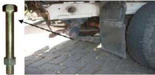
Gambar 1. Bentuk komponen back spring pin dan posisinya pada otomotif.
