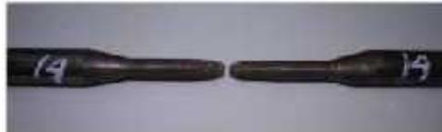
Gambar 12. Spesimen 2 ( patah pada HAZ )
