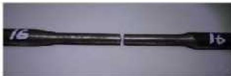
Gambar 14. Spesimen 4( patah pada sambungan )
