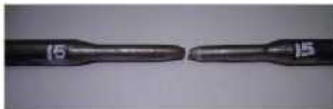
Gambar 13. Spesimen 3 ( patah pada HAZ )
