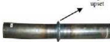
Gambar 9. Benda kerja uji tarik setelah proses las gesek
