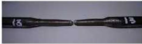
Gambar 11. Spesimen 1 ( patah pada HAZ )
