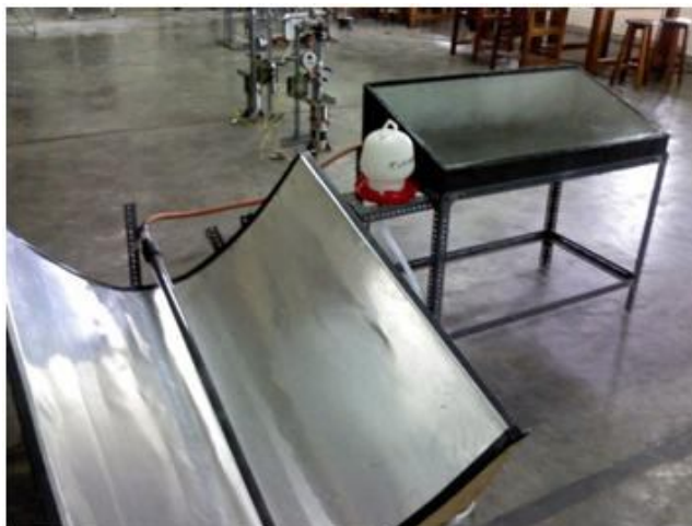
Gambar 3. Alat destilasi energi surya menggunakan kolektor parabola silinder
