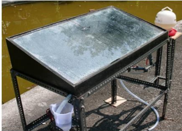
Gambar 1. Bentuk dasar alat destilasi energi surya
