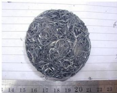
Gambar 6. Limbah gram besi yang sudah dilunakkan dan dioksidasi selanjutnya dicetak menjadi billet.
