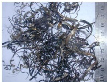
Gambar 3. Gram besi limbah dari proses pembubutan. Limbah ini sangat potensial untuk diolah menjadi alat untuk memurnikan bioas dari gas pengotor H_2S
