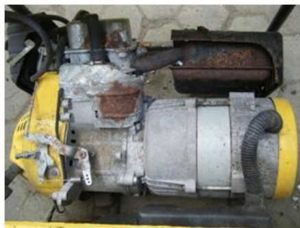
Gambar 3. Kasus korosi parah terjadi pada genset menggunakan bahan bakar biogas akibat kandungan H_2S yang tinggi dalam biogas. Korosi terjadi pada ruang bakar dan knalpot
