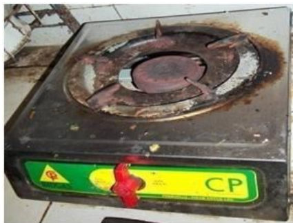
Gambar 2. Kasus korosi parah yang terjadi pada kompor dengan menggunakan bahan bakar biogas karena kandungan gas H_2S yang tinggi
