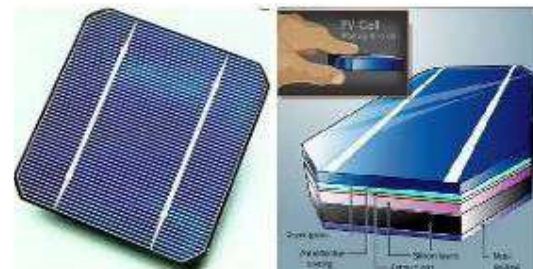
Gambar 3. Keping struktur sel surya dan lapisan sel surya (Sumber: HowStuffWorks)
