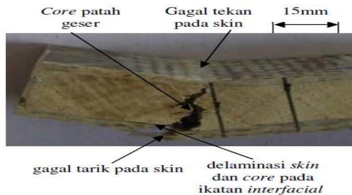
Gambar 8. Penampang patahan komposit sandwich dengan perlakuan NaOH
