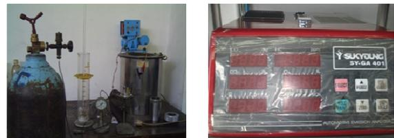
Gambar 1. a) *Calorimeter bomb* b) Alat uji emisi Sukyong SY-GA 401
