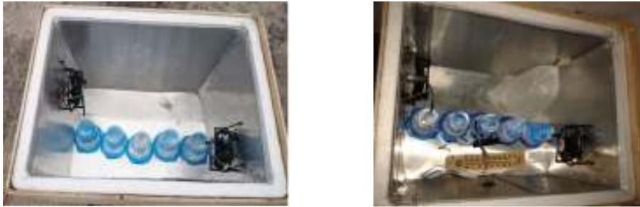
Gambar 3. Kotak pendingin peltier a). tanpa es b). dengan es volume satu liter
