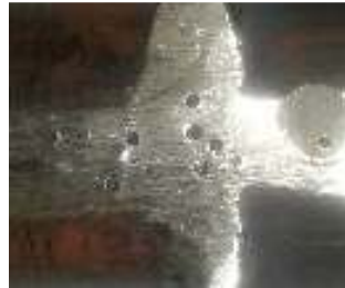
Gambar 9. Benda uji untuk uji kekerasan
