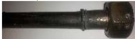
Gambar 8. gambar specimen 3 setelah uji tarik (patah pada sambungan)
