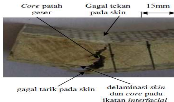
Gamabr 7. Penampang patahan komposit sandwich dengan perlakuan NaOH
