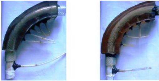
Gambar 5. model uji elbow 90° dengan R/d=4,199 dan R/d=6,299
