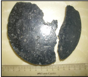
Gambar 7. Deformasi komposit dua lapis bagian belakang.
