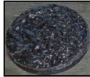
Gambar 1. Komposit polimer diperkuat SiC_p dan serat karbon
