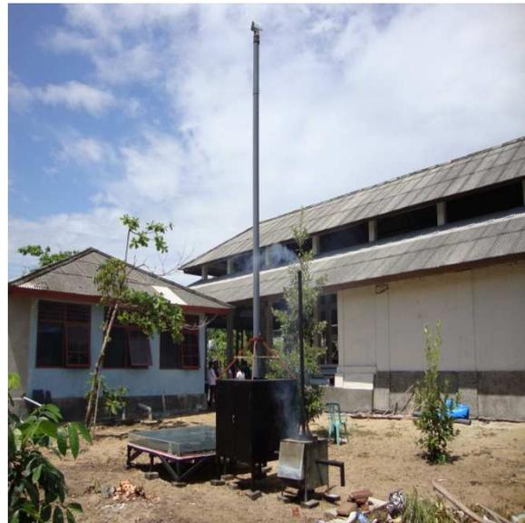
**Gambar 2.** Prototipe pengering ikan aliran alami kombinasi energi kolektor surya dan tungku biomassa
