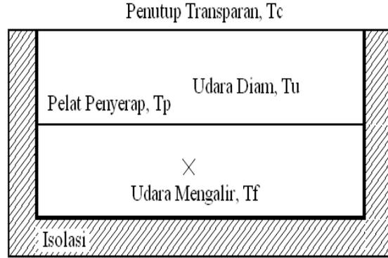
Gambar 1. Kolektor surya pelat datar untuk pemanas udara.
