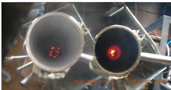
Gambar 6. Pembakaran pada kecepatan superficial 0,05 m/s (500 °C sebelah kiri, 600°C sebelah kanan)
