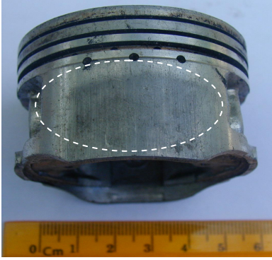
Gambar 1. Bagian yang mengalami kegagalan akibat aus pada piston ditandai dengan garis putus-putus berwarna putih
