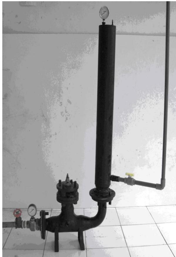
**Gambar 4. Rancangan pompa hydram tanpa dan dengan menggunakan tabung udara**
