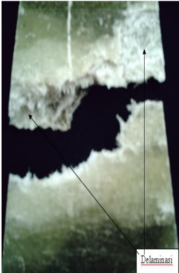
Gambar 12. Delaminasi pada spesimen uji
