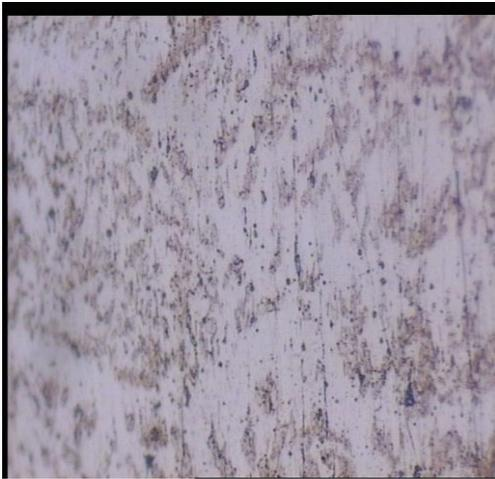
**Gambar 8. Foto mikro filler spesimen E6010 dengan arus 100 Ampere**
