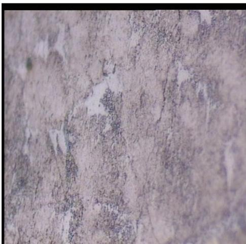
**Gambar 8. Foto mikro base metal spesimen E6010 dengan arus 130 ampere**
