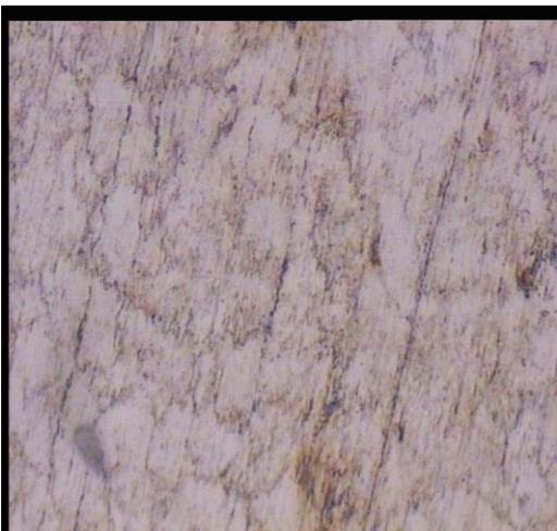
**Gambar 14. Foto mikro base metal spesimen E7018 dengan arus 130 ampere**
