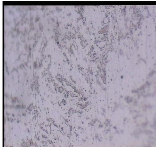
**Gambar 10. Foto mikro filler spesimen E6010 dengan arus 130 ampere**
