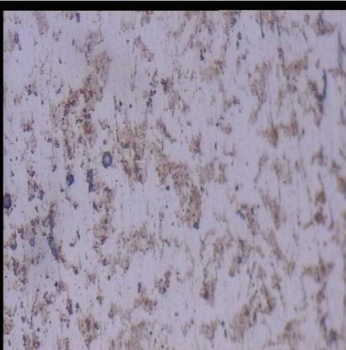
**Gambar 13. Foto mikro filler spesimen E7018 dengan arus 100 ampere**
