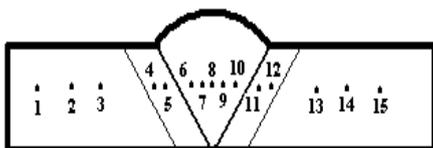
**Gambar 2. Titik pengambilan data kekerasan**
