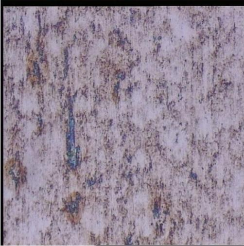
**gambar 12. Foto mikro haz spesimen E7018 dengan arus 100 ampere**
