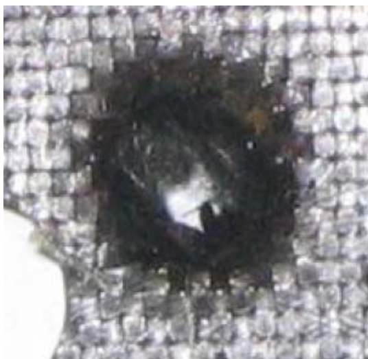
Gambar 3. Hasil proses gurdi dengan gerak makan tinggi (lubang berbentuk elip)
