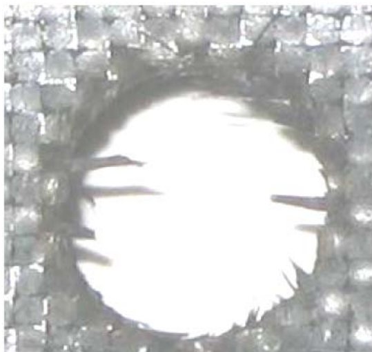
Gambar 2. Hasil proses gurdi dengan gerak makan rendah (lubang sempurna)
