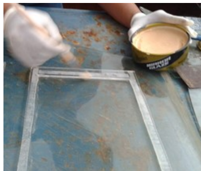
Gambar 7. Pemberian wax pada permukaan panel cetakan
