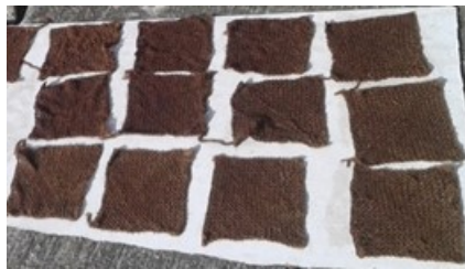
Gambar 6. Pengeringan Tenunan rami setelah perlakuan NaOH
