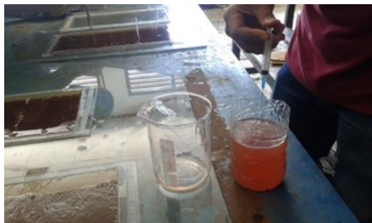
Gambar 8. Pencampuran resin dan hardener
