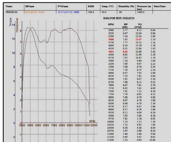
Gambar 3. Grafik performansi mesin menggunakan bahan bakar Premium, sampel data II
