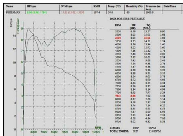
Gambar 7. Grafik performansi mesin menggunakan bahan bakar Pertamina, sampel data II
