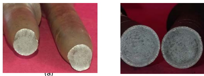
Gambar 5 (a) Penampang patahan raw material (b) Penampang patahan setelah carburizing
