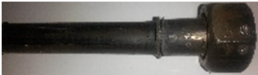
Gambar 8. gambar specimen 3 setelah uji tarik ( patah pada sambungan ).
