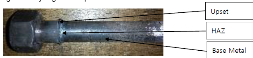
Gambar 4. Contoh benda kerja awal uji tarik yang telah melalui proses friction welding
