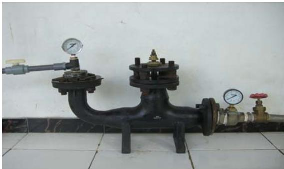
**Gambar 1. Rancangan pompa hidram tanpa menggunakan tabung udara**
