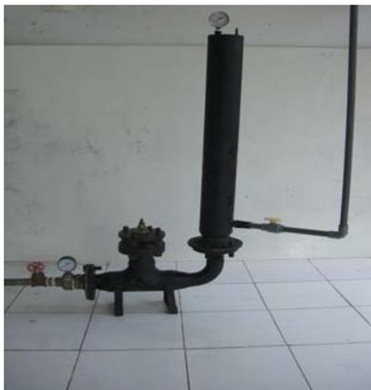
**Gambar 2. Rancangan pompa hidram dengan menggunakan tabung udara**
