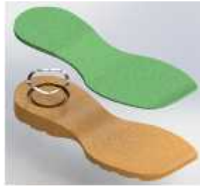
Gambar 1 Susunan sol sepatu dengan penambahan wave spring
