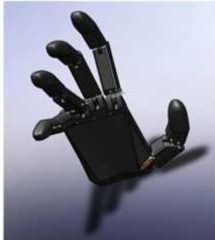
Gambar 2 Disain gripper lima jari yang digerakkan oleh DC servomotor
