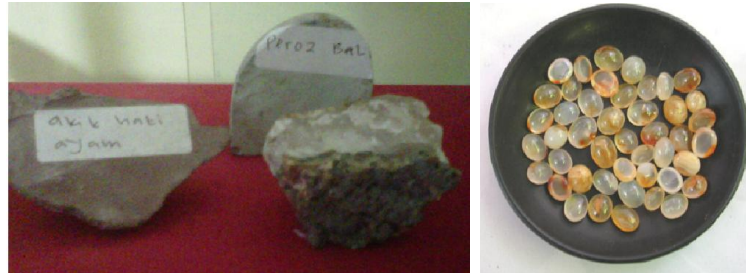
Gambar 4 Contoh batu permata dari bahan batu akik yang belum dan yang sudah diasah dengan mesin pengasah
