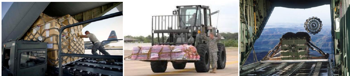
Gambar 1 Kondisi pembebanan pada Pallet (a) yang akan dimasukkan ke dalam pesawat Hercules menggunakan transporter (b) yang akan dimasukkan ke dalam pesawat Hercules menggunakan forklift (c) yang akan diterjunkan keluar pesawat Hercules menggunakan parasut [2, 4].
