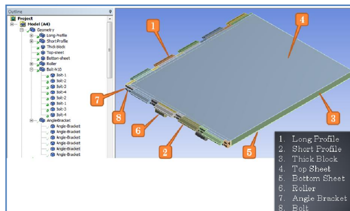
Gambar 9 Geometri nama bagian-bagian pallet.
