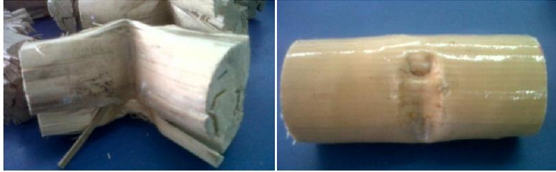
a. bentuk kerusakan impact rotan tanpa laminasi      b. bentuk kerusakan impact rotan dengan laminasi
