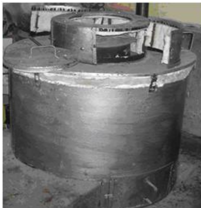
Gambar 3 Tungku pengecoran kuningan berbahan bakar briket batubara non karbonisasi menggunakan kowi silikon karbida berkapasitas 150 kg
