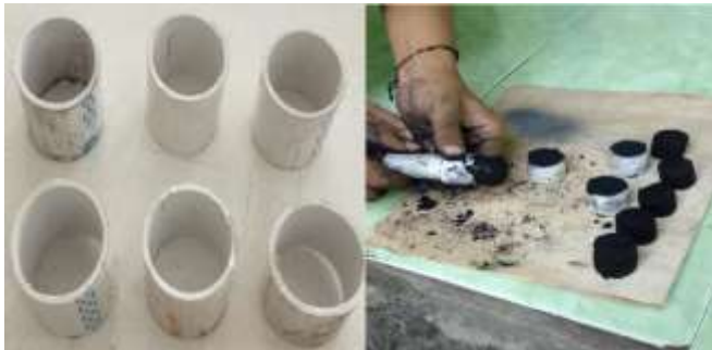
Gambar 1. Cetakan briket dan briket sekam padi
