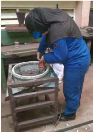
Gambar 2. Proses perakitan Mesin Pemecah Biji Kemiri
