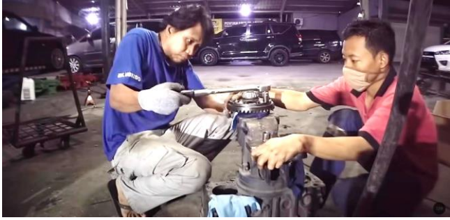
Gambar 7. Proses penggantian gigi gardan
