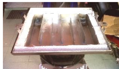
Gambar 3. Kotak penghangat bagian bawah yang dialiri gas buang
