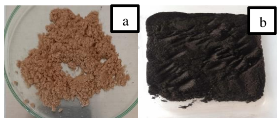
Gambar 1 Serbuk bambu tabah ( B_0 )(a) dan arang bambu tabah ukuran mikron ( AB_0 )
